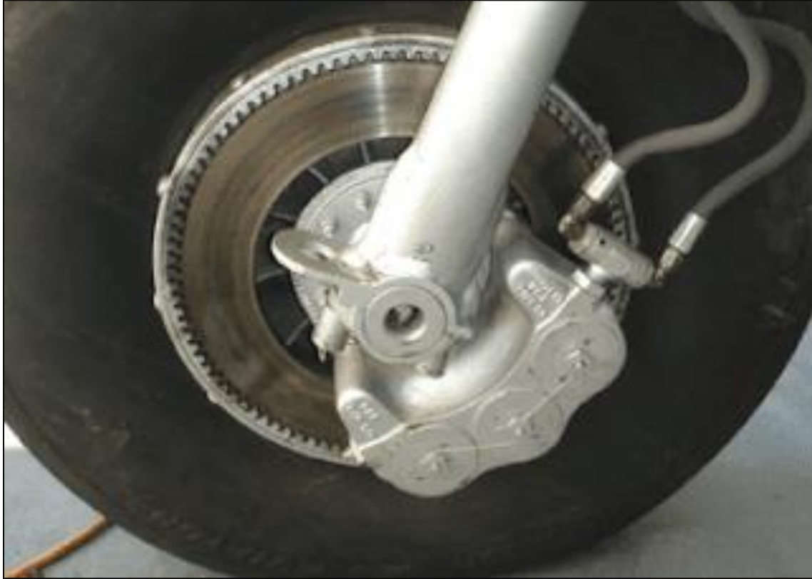
Fotografía No. 6: Un freno de disco único es un freno de pinza fija.
