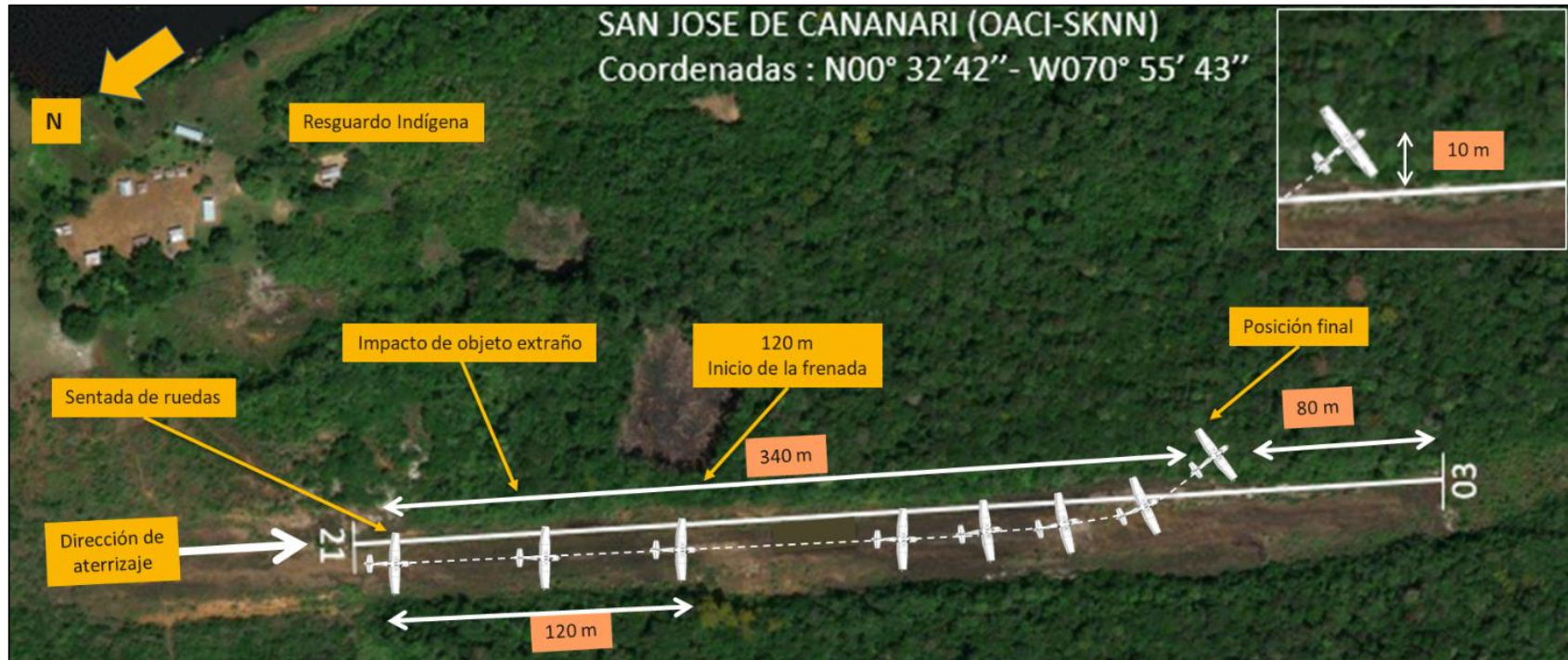
Imagen No. 3: Secuencia de aterrizaje, salida de la pista y posición final de la aeronave.
