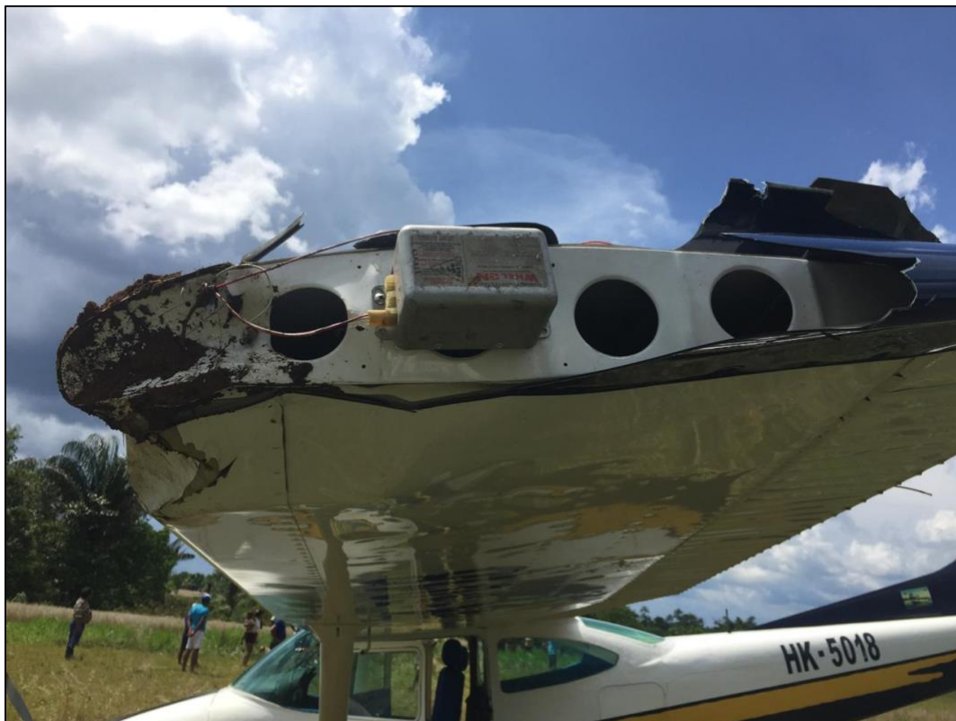
Fotografía No. 4: Daño en el plano derecho
