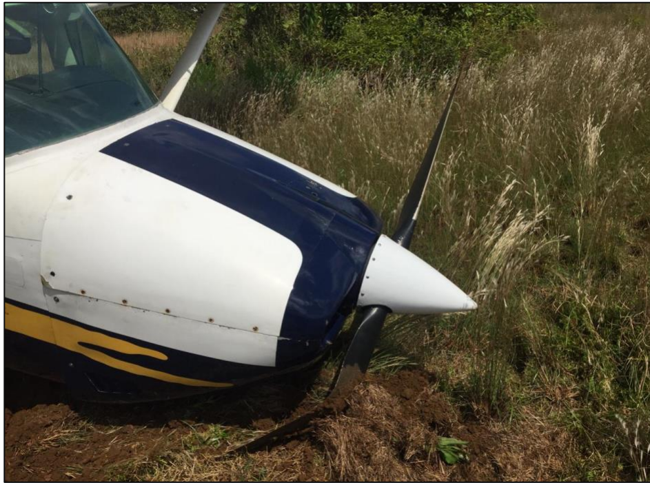
Fotografía No. 3: Daño en la hélice
